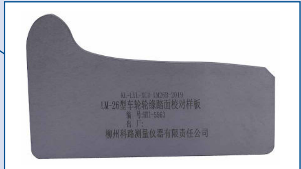
PAD 95.1 | Art.-Nr. 770 018 Prüfmittel zur Prüfung des Grades des Radprofils VKP (netto) 300,- EURO / Stück
