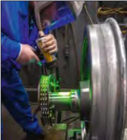
*Magnetpulverprüfung am Achsschenkel,
