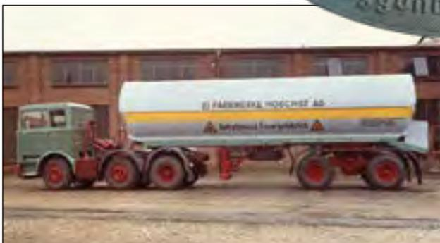
*Der Druckgas-Straßentankauflieger für die Farbwerke Hoechst besaß als Sonderausrüstung zwei Thermometer und ein Manometer. Die Zugmaschine war von Daimler-Benz
