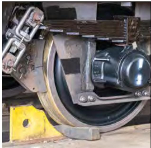
*Laufwerk mit Radsatz- und Bremsklotzsohle
