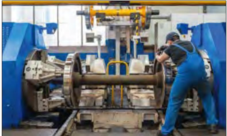
*Die Radsatzdrehmaschine ist seit 2019 im Einsatz
