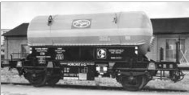
Der zweiachsige Tragwagen 092 7 007 P wurde 1967 für Hoechst gebaut. In den abnehmbaren Behältern wurde Frigen transportiert. Der Wagen war für Normal- und Breitspurgleise geeignet (Franz Kaminski Waggonbau GmbH)
