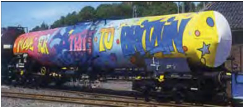
*Kaminski baute zehn solcher Weinkesselwagen für die VTG. Durch den konisch angelegten Behälter war die Flüssigkeitsoberfläche, die mit der Luft in Kontakt kam, besonders klein. Dieser Waggon wurde mit der einseitigen, an Graffiti angelehnten Lackierung 1988 auf der IVA Hamburg ausgestellt (Franz Kaminski Waggonbau GmbH)*
