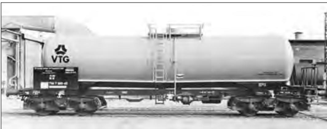
*1987 wurde der Kesselwagen 786 7 688 P für den Transport von Flußsäure für die VTG gebaut (Franz Kaminski Waggonbau GmbH)*
